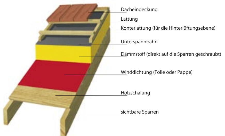
Abb 33 | Aufsparrendämmung
